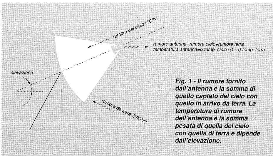
Fig. 1 - Il rumore fornito dall'antenna è la somma di quello captato dal cielo con quello in arrivo da terra. La temperatura di rumore dell'antenna è la somma pesata di quella del cielo con quella di terra e dipende dall'elevazione.
