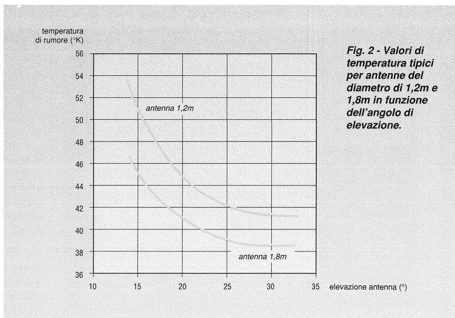
Fig. 2 - Valori di temperatura tipici per antenne del diametro di 1,2m e 1,8m in funzione dell'angolo di elevazione.
